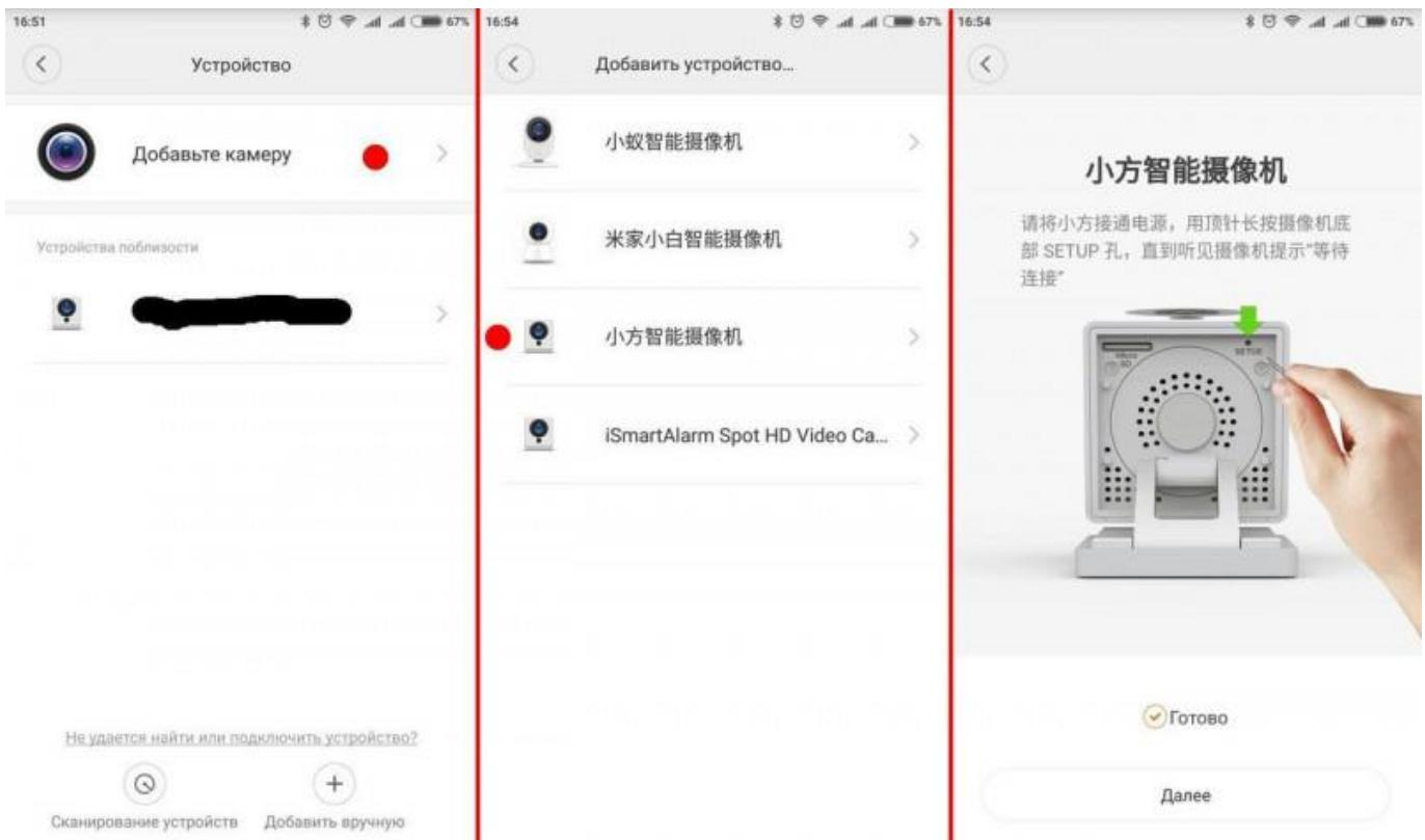
Далее надо ввести пароль от вашего WiFi, приложение сформирует QR-код для передачи информации о точке доступа и ее пароле камере, нужно поднести экран смартфона с этим кодом поближе к камере, чтобы она его считала. Дальше камера произнесет фразу на китайском, затем еще одну, нажимаем дальше, приложение ищет подключенную камеру, дальше камера скажет еще одну фразу, что все ок, индикатор должен светиться синим постоянно.
